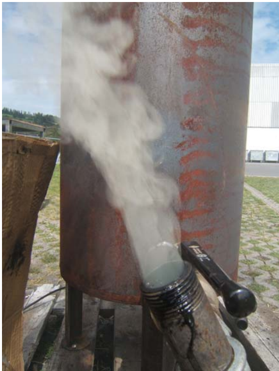
Abb. A33: Bei Kugelhahn 3 austretendes nicht entzündetes Holzgas, welches mittels Gleichstromvergasung von Holzkohle hergestellt wurde ( H_{\text{Gleich}} )
