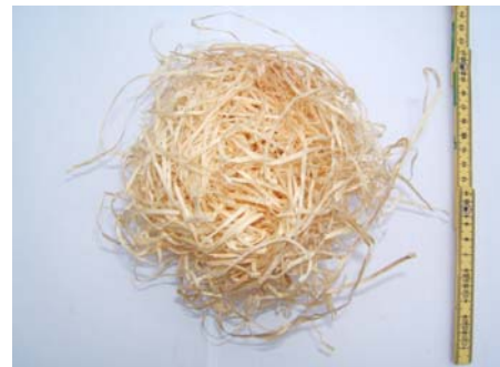
Abb. 13: Unbehandelte Holzwolle zum Anfachen des Feuers im Vergaser
