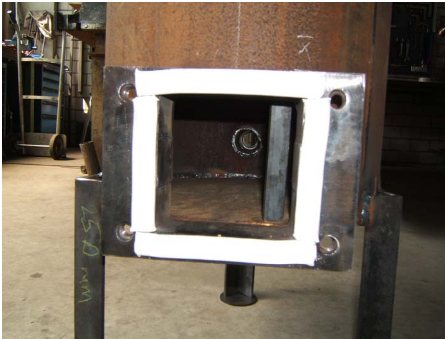
Abb. A29: Sicht durch die Öffnung zum Herausnehmen der Asche (Aschentür entfernt) des selbst konstruierten Vergasers mit Dichtung (weiss)
