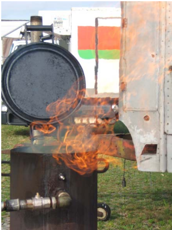
Abb. A31: Selbst konstruierter Vergaser mit geöffnetem Deckel bei der Gegenstromvergasung von Tannenholz ( T_{\text{Gegen}} )
