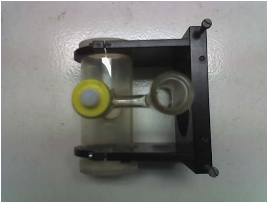
Abb. A35: Messzelle, die in das FT-IR-Spektrometer eingesetzt wurde
