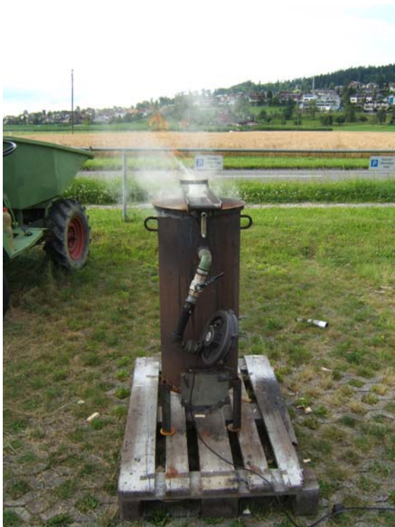
Abb. A32: Selbst konstruierter Vergaser beim Betrieb im Gleichstromverfahren
