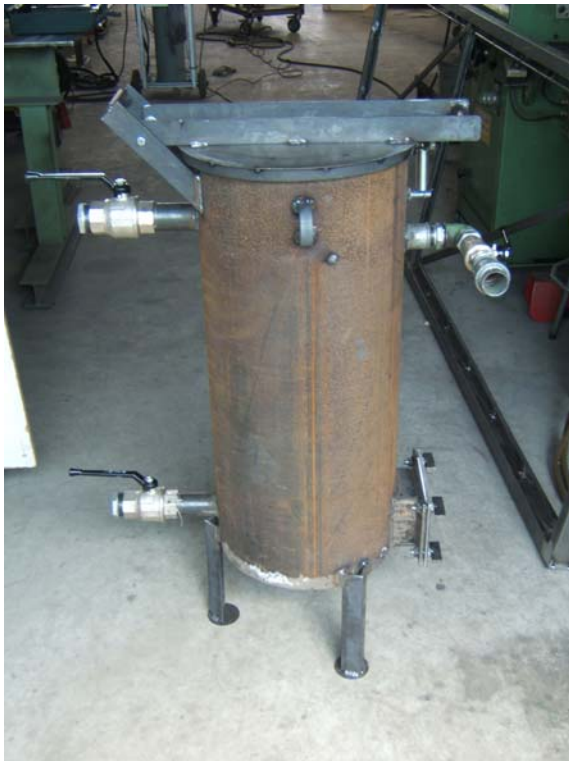
Abb. A27: Selbst konstruierter, noch ungebrauchter Holzvergaser
