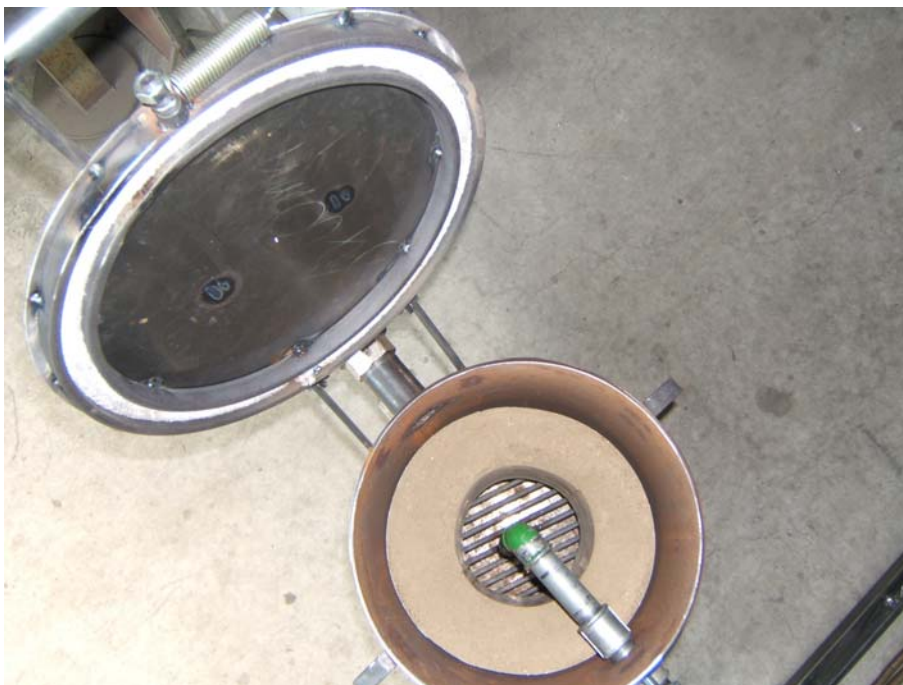
Abb. A28: Aufsicht auf den selbst konstruierten, noch ungebrauchten Vergaser (siehe Abb. A25)
