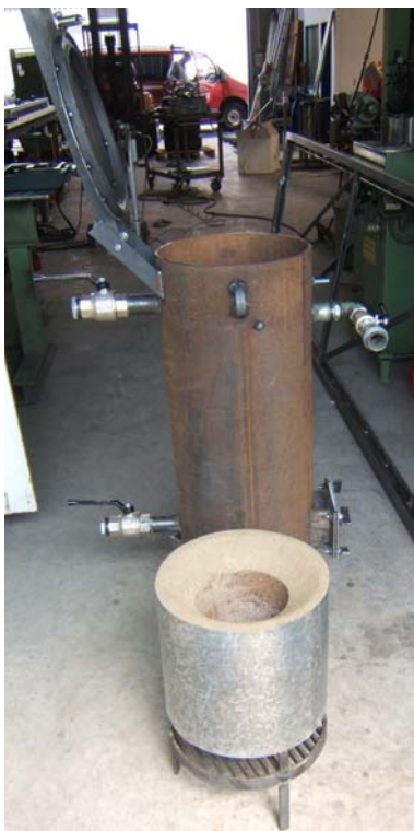
Abb. A30: Selbst konstruierter Vergaser mit geöffnetem Deckel und Schamottzylinder auf dem Rost
