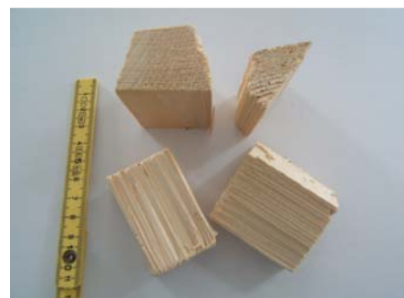
Abb. 9: Gehackte Tannenholzstücke für den Einsatz im Holzvergaser
