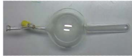
Abb. 12: Glaskolben für den Transport der Holzgasproben zum Ort der Analyse
