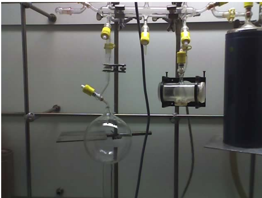
Abb. A36: Vorrichtung zum Übertragen der Holzgasproben vom Glaskolben (links) in die Messzelle (rechts)
