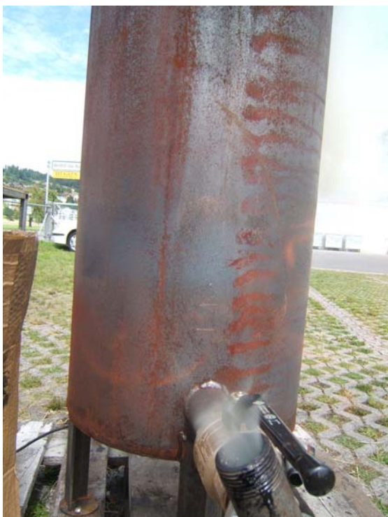
Abb. A34: Bei Kugelhahn 3 austretendes entzündetes Holzgas, welches mittels Gleichstromvergasung von Holzkohle hergestellt wurde ( H_{\text{Gleich}} )
